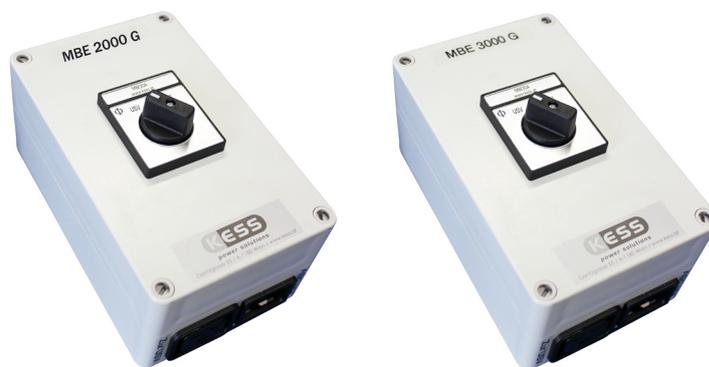
Die MBE2000G und MBE3000G dienen zur Überbrückung Ihres USV-Systems für einen unterbrechungsfreien Austausch oder für Wartungen Ihrer USV-Anlage ohne Abschaltung der Verbraucherlasten. In der Schalterstellung „Netz“ werden die Verbraucher direkt von der Netzeingangsspannung versorgt. In der Schalterstellung „USV“ erfolgt die Versorgung der Verbraucher über die USV-Anlage.
