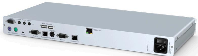
links: CATVision-MC2-ARU2-CPU Rechnermodul
