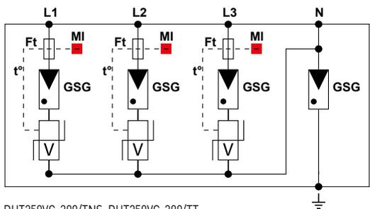
**GSG** : Gasgefüllte Funkenstrecke      **Ft** : Thermische Sicherung
