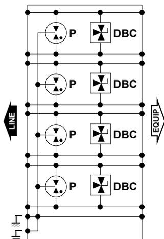
**P** : Gasableiter in 3-Elektroden-Konfiguration
