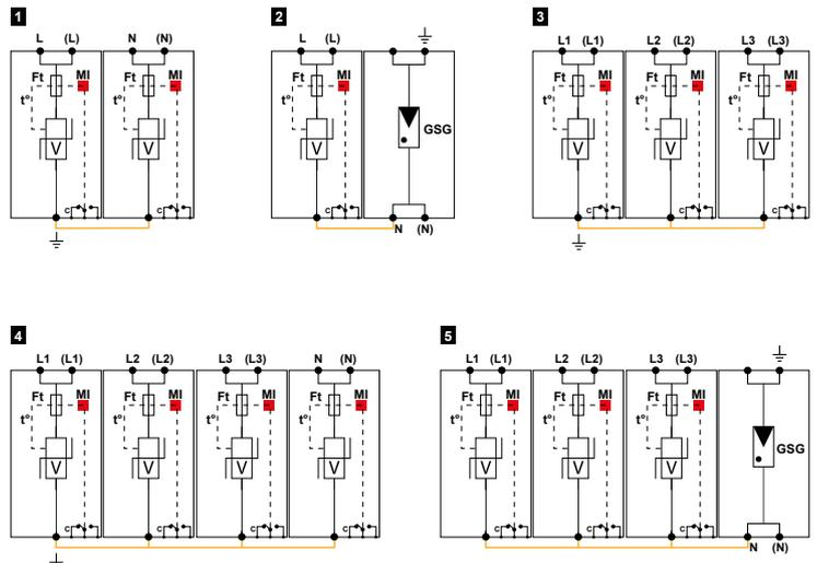
**GSG** : Gasgefüllte Funkenstrecke      **Ft** : Thermische Sicherung
