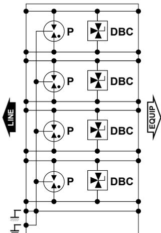
P : Gasableiter in 3-Elektroden-Konfiguration
