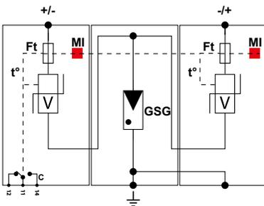
**GSG** : Gasgefüllte Funkenstrecke      **Ft** : Thermische Sicherung
