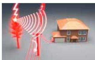
Einkopplung durch Strahlung
