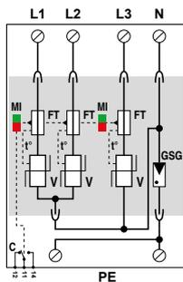
**GSG** : Gasgefüllte Funkenstrecke      **Ft** : Thermische Sicherung
