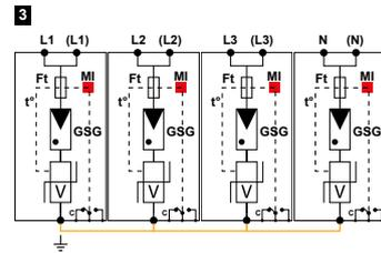
**GSG** : Gasgefüllte Funkenstrecke      **Ft** : Thermische Sicherung
