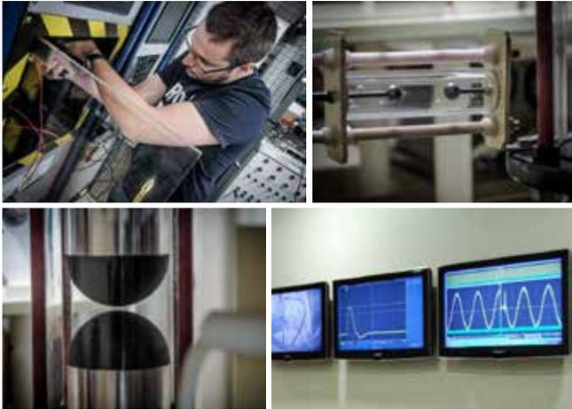
Der Prüfgenerator G100K in Reims (Frankreich) kann einen außergewöhnlich hohen Impulsstrom von 100 kA (10/350µs) erzeugen und wird für die Prüfung von baulichen Blitzschutzsystemen sowie von Überspannungsschutzgeräten des Typs 1 eingesetzt.
