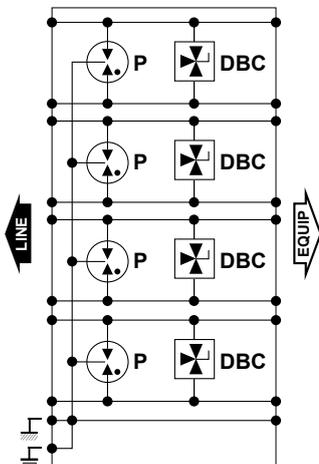
**P** : Gasableiter in 3-Elektroden-Konfiguration
