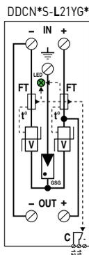
**GSG** : Gasgefüllte Funkenstrecke    **Ft** : Thermische Sicherung
