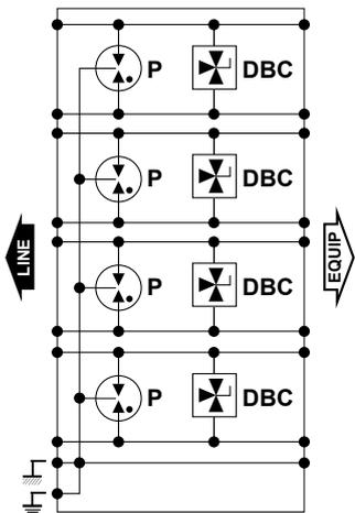
**P** : Gasableiter in 3-Elektroden-Konfiguration
