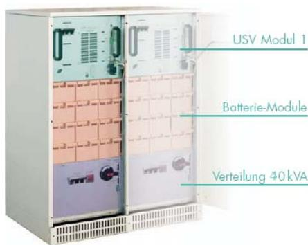
Die Conceptpower Classic beinhaltet ein USV-Modul von 10, 15, 20, 30 oder 40 kVA plus zusätzlichen Batterien in einem Schrank. Zur Leistungserhöhung oder Redundanz kann immer wieder ein Classic-Schrank hinzugefügt und parallel geschaltet werden.
