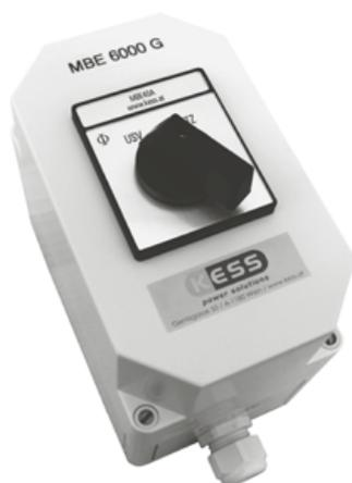
Die MBE6000G, MBE8000G und MBE11000G dienen zur Überbrückung Ihres USV-Systems für einen unterbrechungsfreien Austausch oder für die Wartung Ihrer USV-Anlage ohne Abschaltung der Verbraucherlasten. In der Schalterstellung „Netz“ werden die Verbraucher direkt von der Netzeingangsspannung versorgt. In der Schalterstellung „USV“ erfolgt die Versorgung der Verbraucher über die USV-Anlage.
