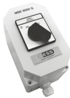
Die Bypass-Schalter MBE6000G, MBE8000G und MBE11000G dienen zur Umgehung Ihres USV-Systems und ermöglichen einen unterbrechungsfreien Austausch Ihrer USV-Anlage ohne Abschaltung der Verbraucherlasten. In der Schalterstellung „Netz“ werden die Verbraucher direkt von der Netzeingangsspannung versorgt. In der Schalterstellung „USV“ erfolgt die Versorgung der Verbraucher über die USV-Anlage.
